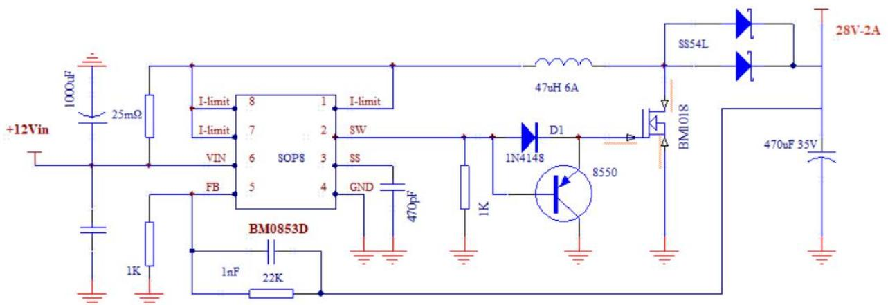
对于低压输出应用，第三脚的电容用270pF-680pF
