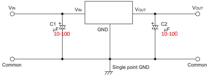
大电流输出正电压调节器
