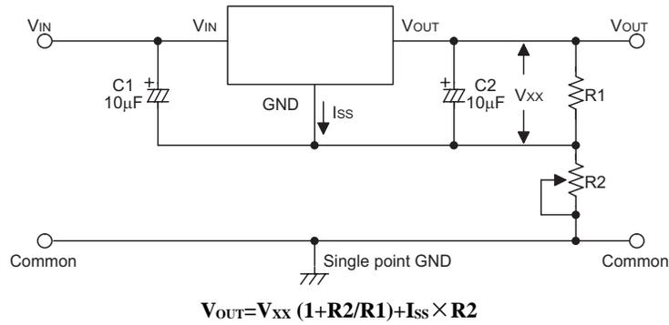
用于增加输出电压的电路
