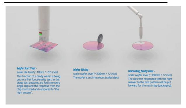
线拉完之后,芯片本身的制作就完成了。接下来是简单的测试,将一组特定的讯号送入 芯片中,再比较输出的结果,看看有没有什么明显的大错误。然后晶圆被切割成一片片 的芯片,先前测试不过关的不良品就此被抛弃。
